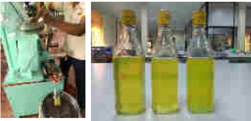
ඉස්කුරුපු පීඩන තෙල් නිස්සාරකය මඟින් තෙල් නිස්සාරණය කිරීම සහ නිස්සාරණය කරන ලද රටකපු තෙල් නියැදිය
